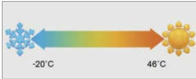
Применение технологии EVI (расширенный инжекторный впрыск) позволяет реализовать устойчивую работу теплового насоса в широком диапазоне наружных температур: от -20 °C до 46 °C.
