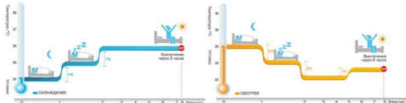
В режиме охлаждения температурная уставка повышается на 1 °C в течение 1-го часа, затем еще на 1 °C в течение последующего часа. Такая температура поддерживается на протяжении дальнейших 6 часов, после чего кондиционер выключается.
