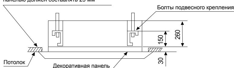
Примечание. Проектировочный размер интегрируемой части панели PB-620KB равен 583 мм.
