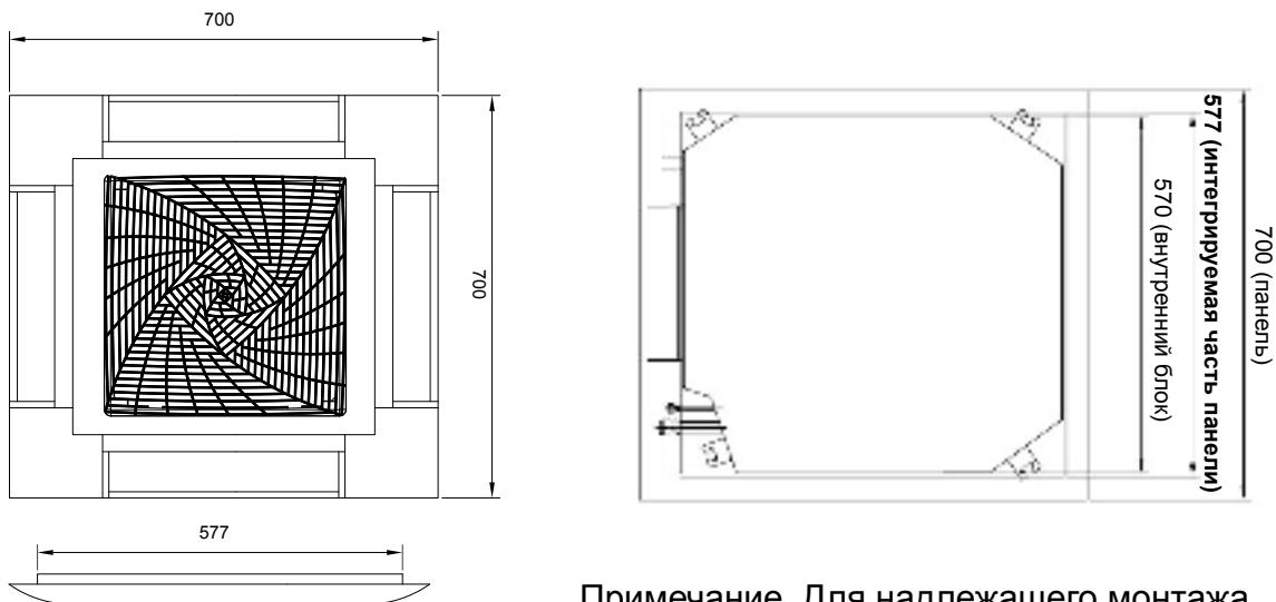
Примечание. Для надлежащего монтажа панели PB-700KB ширина потолочного проема должна составлять не менее 577 мм.
