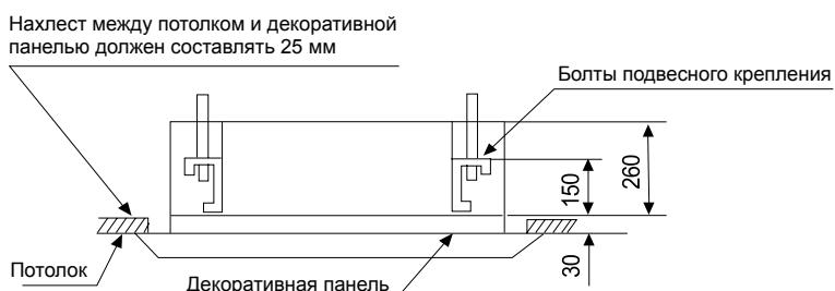
Примечание. Проектировочный размер интегрируемой части панели PB-700KB равен 577 мм.
